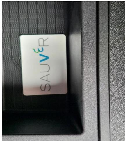
*Vous devez placer la carte SAUVÉR vis-à-vis du lecteur de carte situé en bas à gauche du pare-brise du côté conducteur. Cela permettra de réactiver le véhicule.*
