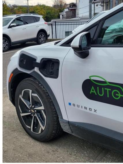
Allez au poteau de la borne de recharge, branchez le pistolet du câble de recharge (connecteur de recharge) dans le port de charge.
