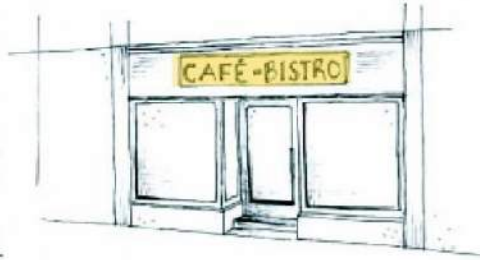
Enseigne posée à plat
